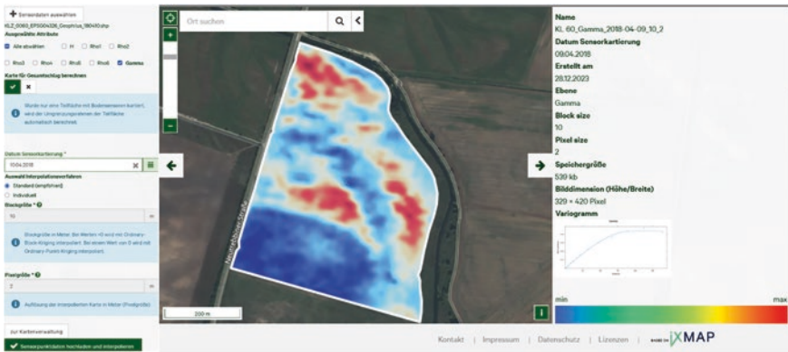
Abb. 8.3 Ergebnis der Dateninterpolation für die gemessenen Gamma-Werte des Geophilus Sensorsystems für einen Beispielschlag (KL60)
