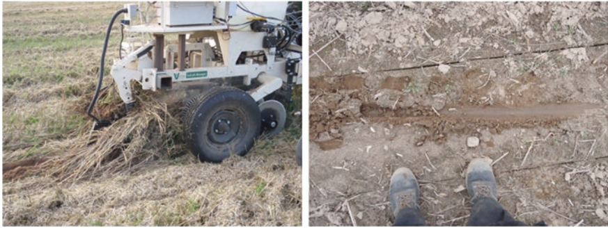
Abb. 4.10 Probleme durch Verstopfung (links) und Verdichtung (rechts) (R. Gebbers)
