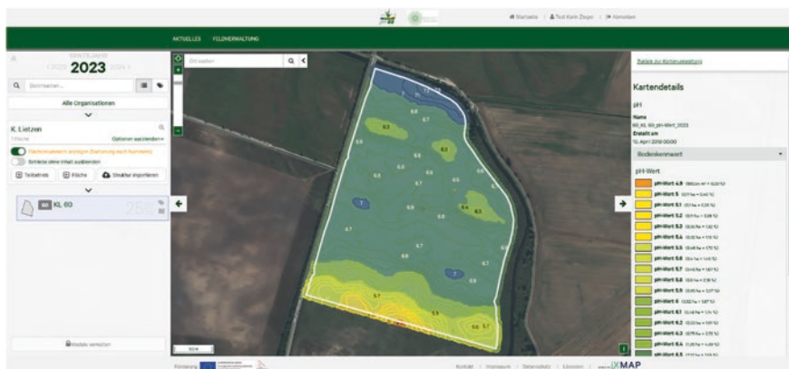
Abb. 8.5 Ergebnis der kalibrierten pH-Karte, die auf Basis von 10 im Labor gemessenen pH-Werten (nach \text{CaCl}_2 ) und den pH-Sensordaten des pH-Managers berechnet wurde
