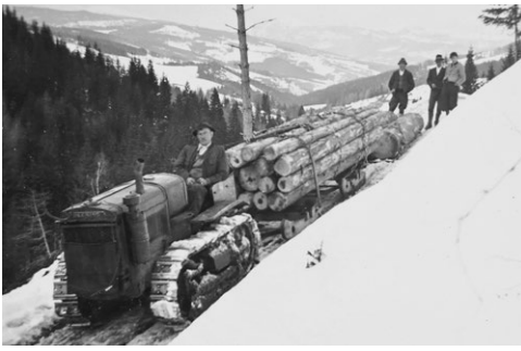
Holzbringung mit Raupenschlepper und Schlitten.
