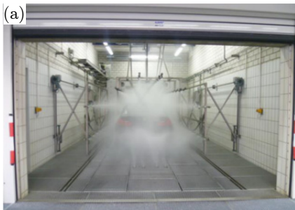
Bild 84: Dichtheitsprüfanlage (a) am Realfahrzeug & (b) im Experiment, vgl. [S3, Abbildungen 53 und 59], eigene Darstellung
