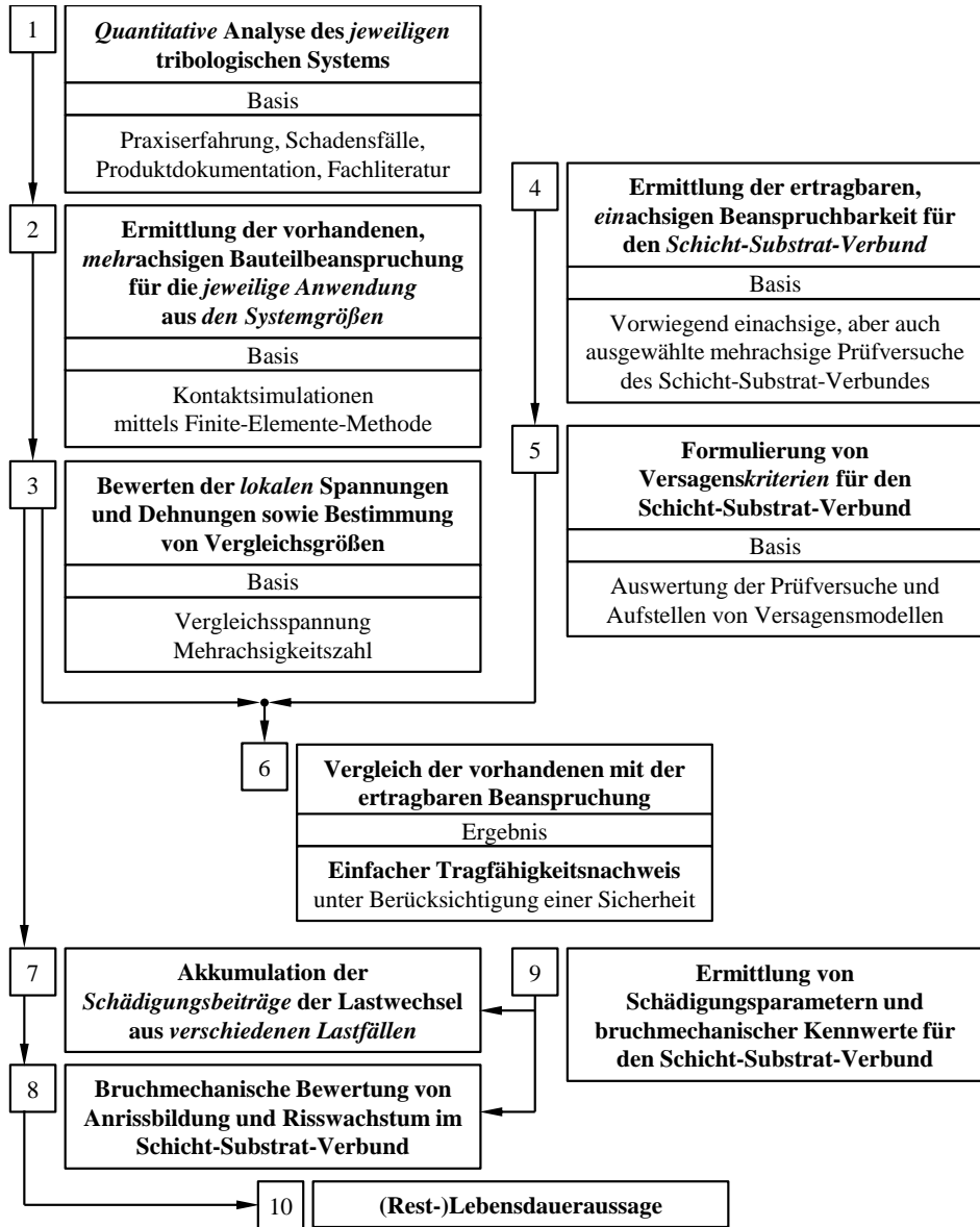
Bild 9: Konzeptstruktur für den Tragfähigkeitsnachweis und die Lebensdauerabschätzung von Schicht-Substrat-Verbunden unter zyklischer Beanspruchung [43]
