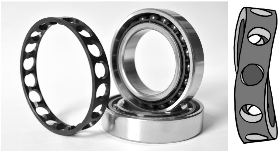
Bild 81: Kunststoffkäfige von schnelldrehenden Spindellagern (links) mit typischer Verformung bei hohen Drehzahlen in überzeichneter Darstellung (rechts)
