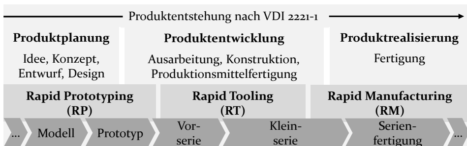
Bild 2: Prozesskette der Produktentstehung im AM (in Anlehnung an [Gebhardt, 2016; Lachmayer et al., 2016])
