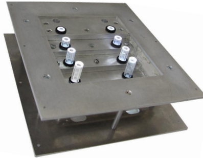
Bild 10: Versuchsstand zur Integration beleuchteter Referenzierungsrohre in eine gestufte Bauplattform zur Analyse des Beleuchtungseinflusses durch unterschiedliche Pulverschichtdicken
