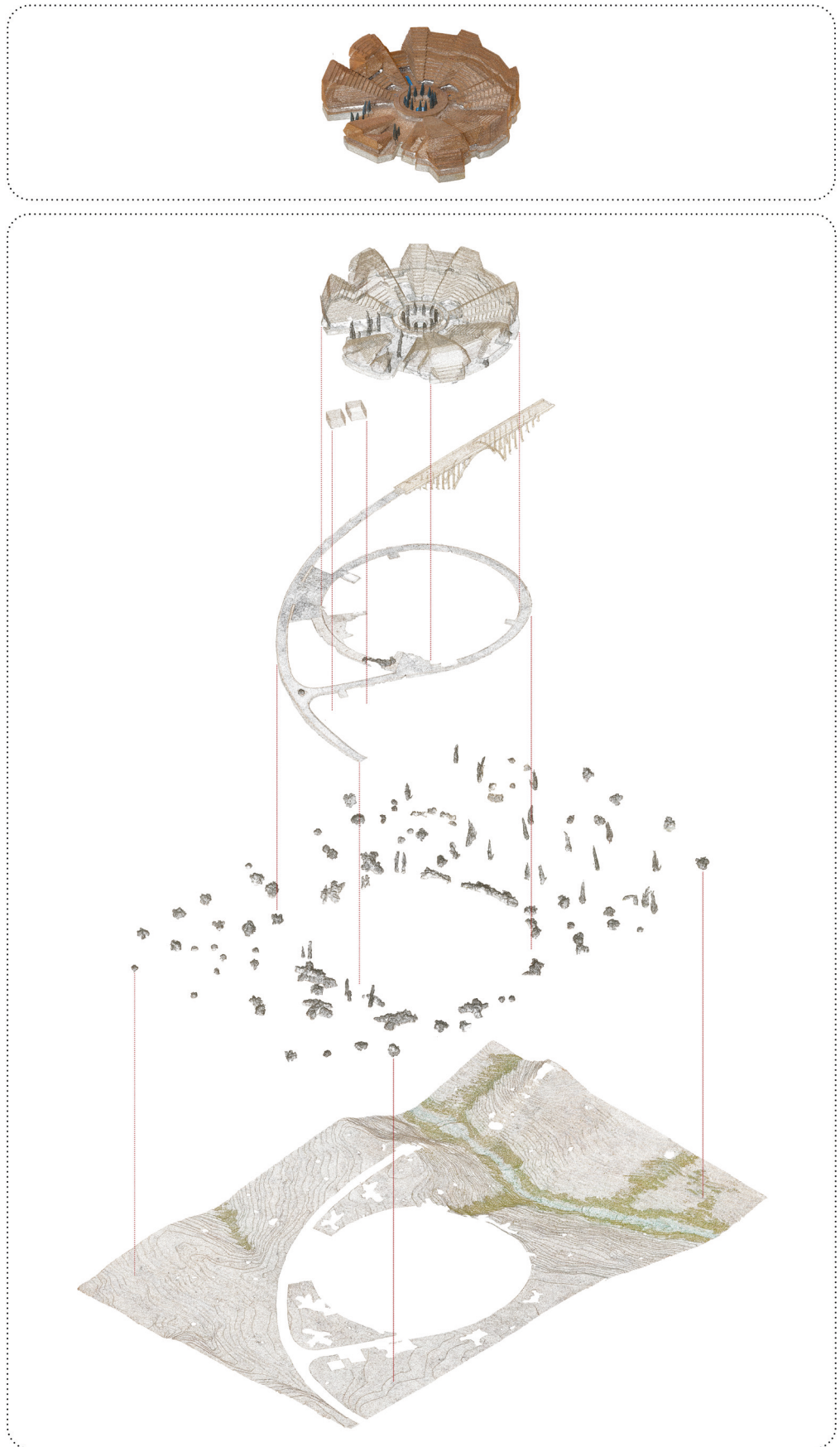
Fig. 7. Segmentazione delle nuvole di punti dense ottenute dalla fotogrammetria dei due modelli architettonici conservati presso il Servicio Histórico del COAM (in alto) e presso l'archivio storico del IPCE (in basso), Madrid (elaborazione di S. Cera).
