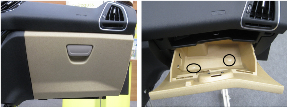
Abb. 63: Spritzgegossenes Handschuhfach aus Sisal/PP. Links: Handschuhfach in einer Ford B-MAX Instrumententafel. Rechts: Geöffnetes Handschuhfach, oberflächlich sind zwei kleine Stellen mit Weißbruch sichtbar (schwarze Umrandung).
