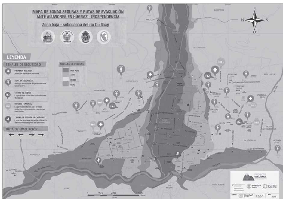
FIGURE 8.3. The flood hazard map of Huaraz. (Courtesy of Proyecto Glaciares)
