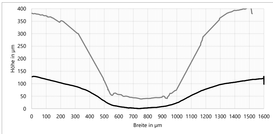
Prägelinie mit 500 µm Breite
