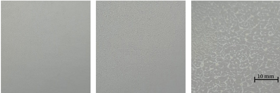
Abb. 27 Visuell inhomogene Oberflächen der mit 140T Sieb bedruckten B4 Proben, Links: \text{CNF}_2 doppelt bedruckt, mitte: \text{CNF}_1 doppelt bedruckt, rechts: \text{CNF}_{0,5} einfach bedruckt Aufgenommen mit einer Sony Alpha 6000 Systemkamera
