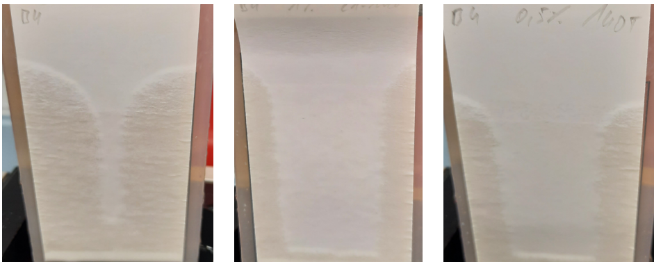
Abb. 37 Die bedruckten Proben von B4 zeigen eine geringere seitliche Penetration als die unbedruckten Proben. Links: B4 unbedruckt, Mitte: Bedruckt mit 21-140 CNF 1 , Rechts: Bedruckt mit 140T CNF 0,5 . Auch diese Proben weisen eine Breite von 50 mm auf.
