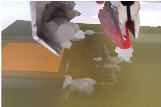
Abb. 24 Aufbauen von CNF_2 an Flut- und Druckrakel während des Siebdrucks
