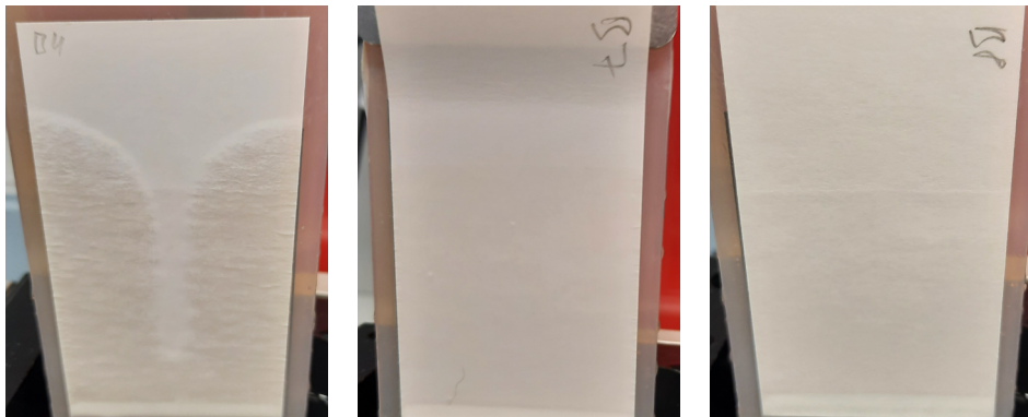
Abb. 36 Unbedruckte Proben der drei Kartonsorten B4, B7 und B8 (v.l.n.r.) nach 30 s Messung
