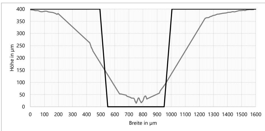
Prägelinie mit 400 µm Breite
