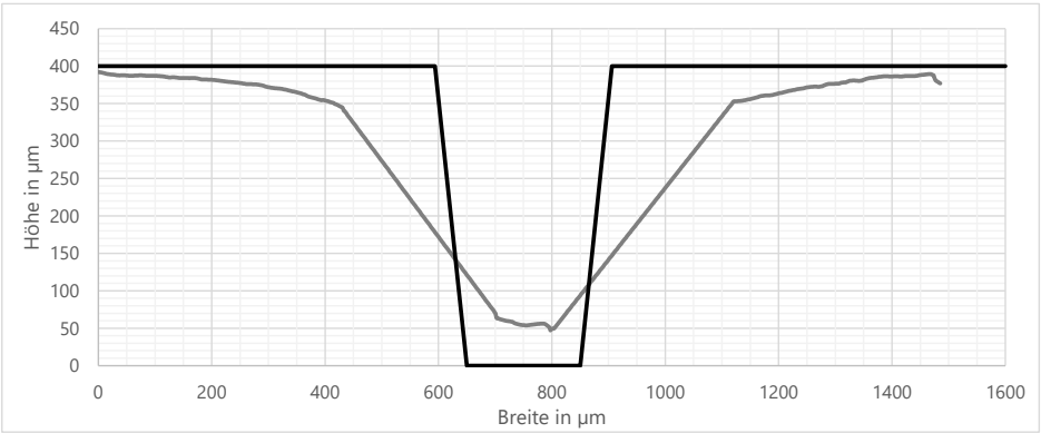
Abb. 55 Vergleich des Querschnitts der 200 µm breiten Prägelinie von CAD-Daten (schwarz) und des tatsächlich produzierten Prägewerkzeugs (grau). Eine vollständige Übersicht aller Prägelinien des neuen Prägewerkzeugs befindet sich in Anhang G.2 .
