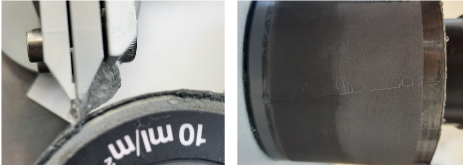
Abb. 25 CNF 1 im Tiefdruck, Links: Aufbau am Rakel und fehlender Kontakt zur Rasterwalze, Rechts: ungleichmäßiges Einfärben der Rasterwalze durch einseitigen Kontakt des Druckfluids
