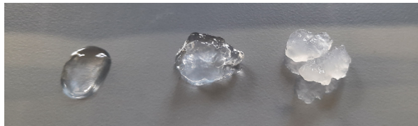
Abb. 20 Nanocellulose in drei Konzentrationen, zur Verfügung gestellt von RISE Schweden Links: CNF_{0,5} , Mitte: CNF_1 , Rechts: CNF_2
