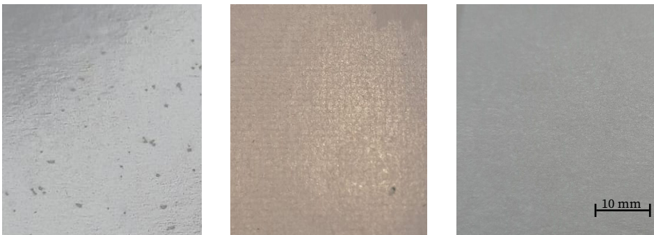
Abb. 28 Visuell inhomogene Oberflächen der mit 21-140 Sieb bedruckten Proben, Links: B4 \text{CNF}_1 , Mitte: B7 \text{CNF}_2 , Rechts: B8 \text{CNF}_1 Aufgenommen mit einer Sony Alpha 6000 Systemkamera
