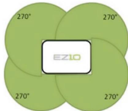
**Abb. 5.5** Sichtfeld Multi-LIDAR zur Hinderniserkennung. (Quelle: EasyMile o. J.)
