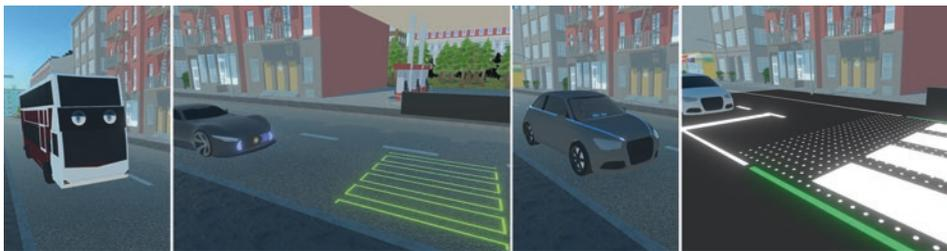
**Abb. 7.1** Darstellung bereits vorgestellter Konzepte für AV-VRU-Kommunikation (von links nach rechts): Anblicken/Nachverfolgen eines VRUs mit künstlichen Augen, Projektion eines Fußgängerüberwegs, LED-Streifen und Displays, bzw. „Smart Infrastructure“ (Fußgängerübergang in der Straße integriert). (Quelle: eigene Darstellung)
