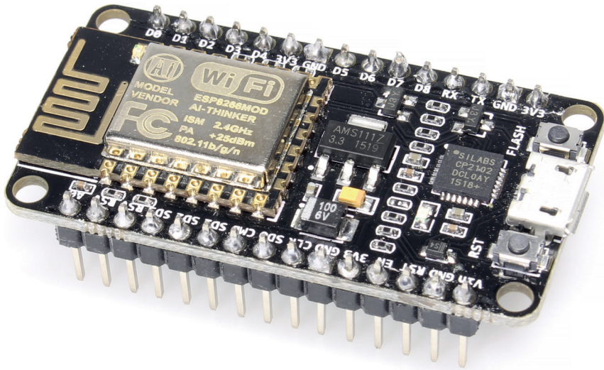
Abb. 8 NodeMCU-Entwicklerboard mit ESP8266 [75]
