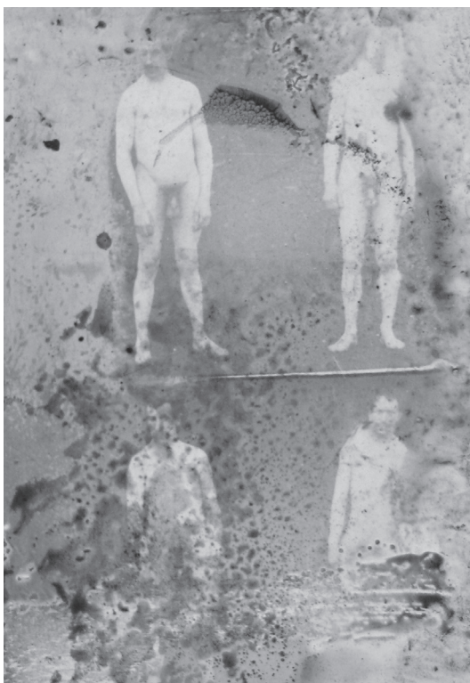
8.3 Frames of a film on a nitrate base in an advanced state of decay. Source: Collection Vincenzo Neri, Archivio Nazionale del Film di Famiglia – Associazione Home Movies /La Camera Ottica, Università degli Studi di Udine.
