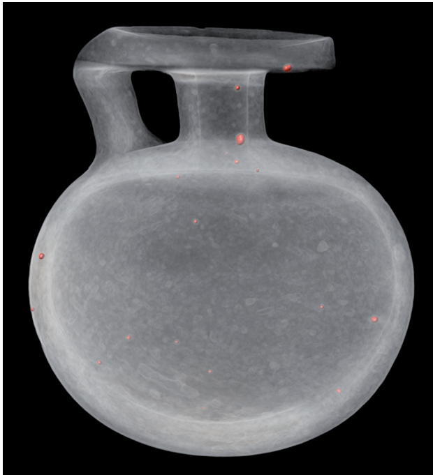
Abb. 11: DVR-Darstellung des korinthischen Kugelaryballos CT02187 (UMJ Inv.-Nr. 8738) unter Verwendung einer Dichte/Gradienten-Transferfunktion, dichte (metallische) Einschlüsse in der Keramikmatrix rot eingefärbt; VRVis Volume Renderer (Visualisierung ÖGI, J. Rosc)
