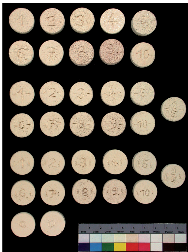
Abb. 36: Unterschiedlich gemagerte Keramikzylinder mit Kennzeichnung ihrer jeweiligen Magerungsart und Korngröße (fein/grob), 24 Stunden nach erfolgtem Brand (Foto S. Karl)
