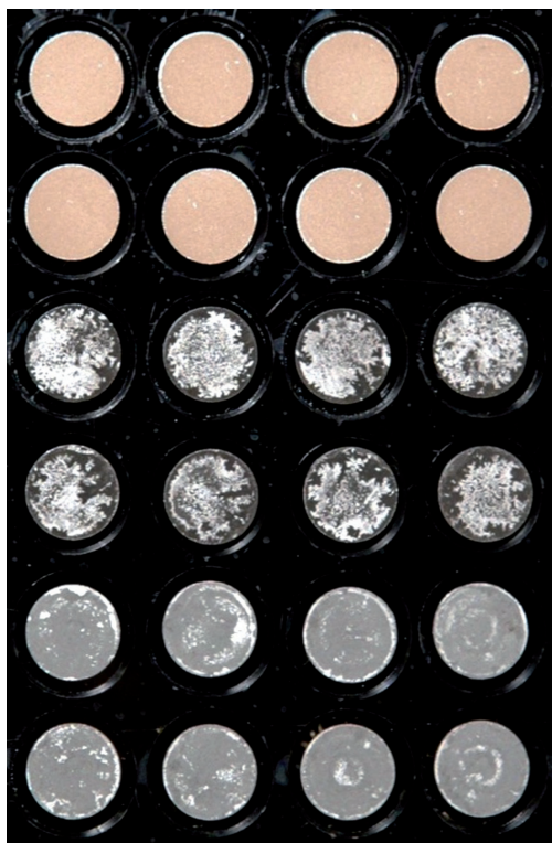
Abb. 17: Auf den Glasträger aufsedimentierte Proben mit unterschiedlich gleichmäßiger Belegung; oben: Idealfall; Mitte: sehr schlecht, Probe C/1; unten: akzeptabel, Probe A/4 (Foto R. Erlach)
