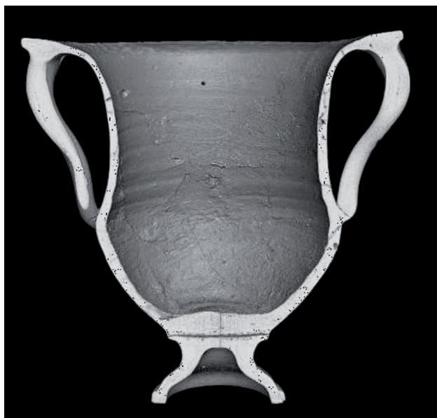
Abb. 49: Etruskisch rotfiguriger Kolonettenkrater im Volterranner Stil, UMJ Inv.-Nr. 4612; im virtuellen CT-Profileschnitt Bruchkanten, ergänzte Fehlstellen und die inhomogene Keramikstruktur des Kraters (Visualisierung R. Fürhacker)
