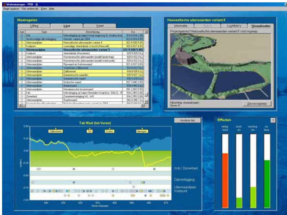
Figura 5. Una schermata del Planning Kit. A sinistra in alto la lista dei possibili interventi. A destra in alto la visualizzazione di un intervento selezionato. A sinistra in basso i livelli idrici ottenuti. A destra in basso gli effetti in termini di: sicurezza, costi, abitazioni e qualità ambientale.
