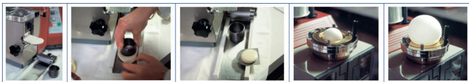
Différentes étapes de préparation et de la déformation de la pâte à l'alvéographe Chopin. Source : Roussel P., Chiron H., 2002.
