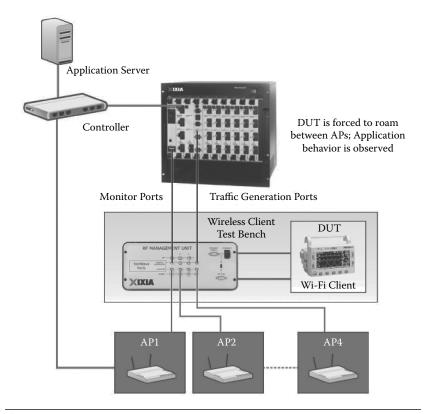
Figure 10.5 Ixia Waveclient. (Courtesy of Ixia Networks.)
