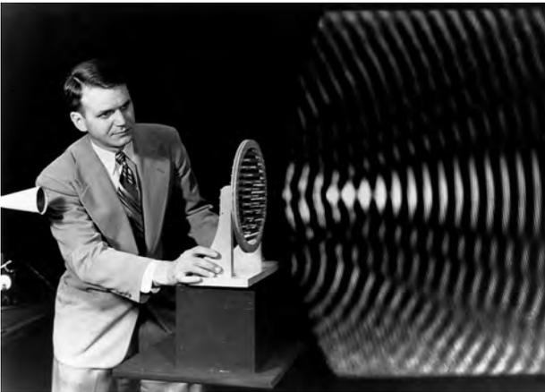
5.08 Mit Hilfe des fokussierenden Effekts einer akustischen Linse, einem winzigen Mikrophon und einer schwingenden Fluoreszenzröhre konnten Floyd K. Harvey (im Bild) und Winston E. Kock an den Bell Laboratories in einer Langzeitbelichtung Schallwellen fotografieren. Die Aufnahme ist rückseitig auf den 14. Juni 1950 datiert.
