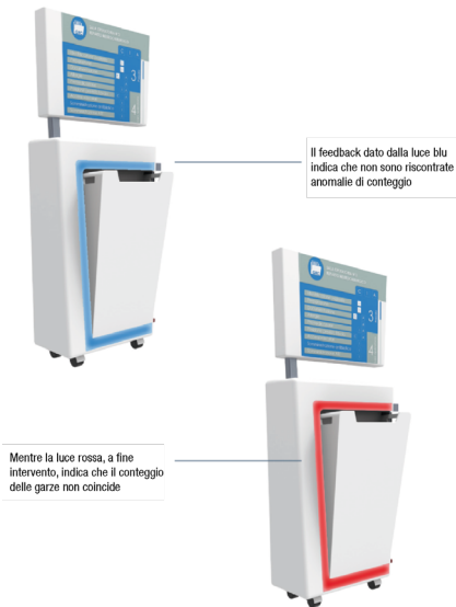
Fig. 2.8 Amyna. Tavolo servitore e dispositivo conta garze. Fonte: Tesi di Laurea Magistrale in Design, © Giovanni Russo.
