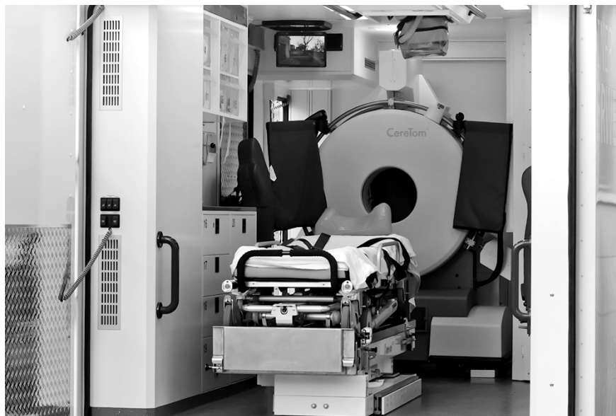
Abb. 1 Ansicht des STEMO von innen mit Darstellung der Patientenliege und des CTs in einem durch Blei abgeschirmten Raum (Foto: Sebastian Dörken)
