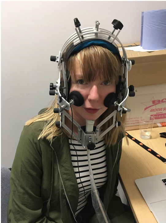
Kuva 1. Ultraäänilaitteisto kiinnitystelineineen. Signaali siirrytään analyysia varten tietokoneelle.
