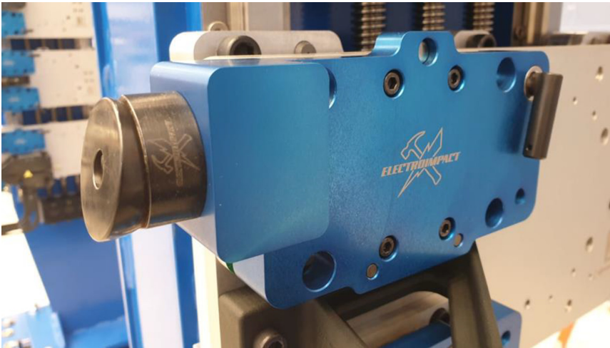
Fig. 14. EI swivel index assembly on the VADIS Jig
