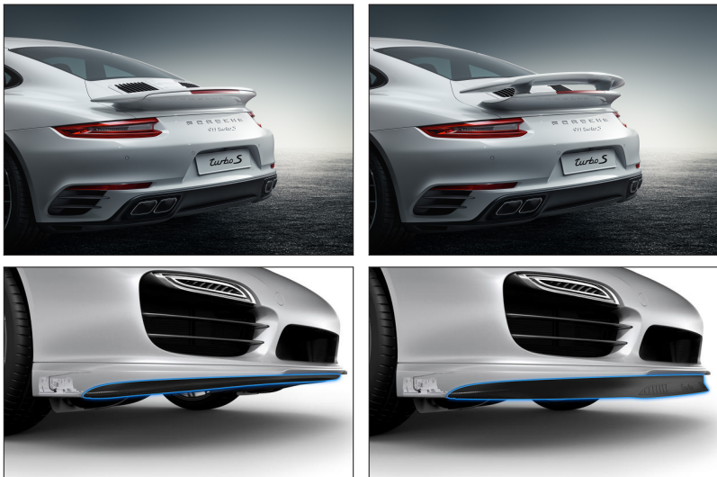
Abb. 4.1: Ausfahrbarer Heckflügel und verstellbarer Bugspoiler eines Porsche 911 Turbo. ©Dr. Ing. h.c. F. Porsche AG
