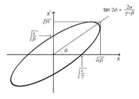
Fig. 1.2. Ellipse parameters for the beam matrix [28, 29]
