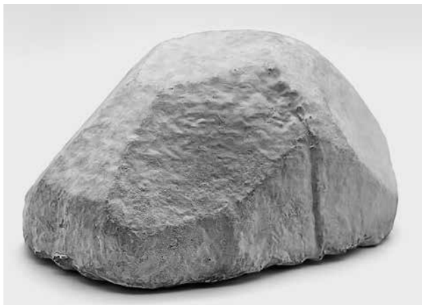
8 Fertig gewachsener Helmprototyp aus Fomes fomentarius , Hanf- und Rapsstroh
