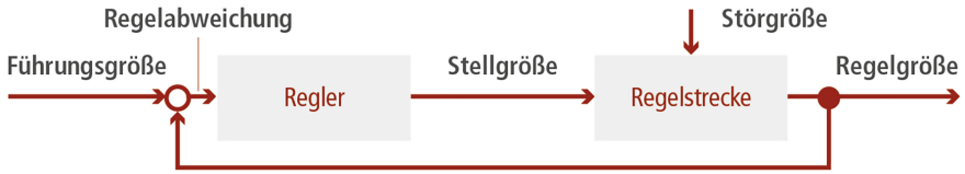
Abb. 3. Darstellung eines klassischen Regelkreises, bestehend aus Regelstrecke und Regler (Lunze 2010)
