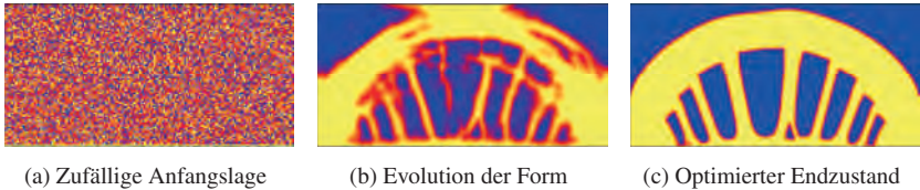
Abbildung 4.23: Optimierung einer Brückenstruktur aus einer zufälligen Anfangslage
