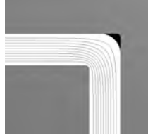
Abbildung 5.10: Vergleich einer durchströmten Struktur eines 90° Krümmers vor der Optimierung (grau) und den durch die Optimierung mit dem J_5 -Terms entfernten Bereich (schwarz).
