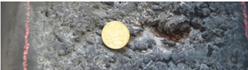
Abbildung 9.8: Verschlissener Rotorpumpenschlauch (10 Cent-Münze zum Größenvergleich); Funktion nach dem Steinverfahren 2.1 Elastische Partner, in welche die Fremdkörper eingebettet bzw. integriert werden
