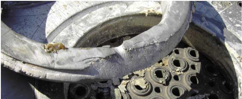
Abbildung 9.3: Schneidring mit Strahlverschleiß (PUTZMEISTER ENGINEERING GMBH)
