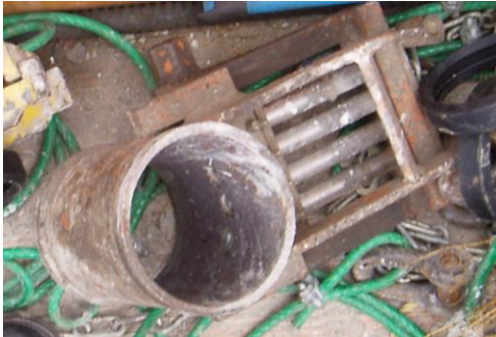
Abbildung 9.9: Handbetätigtes Sperrventil ; Funktion nach dem Steinverfahren 2.2 Stopfer gezielt erzeugen und wieder aufheben (PUTZMEISTER ENGINEERING GMBH)
