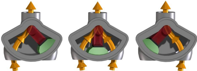
Abbildung 10.2: Die drei Schaltstellungen des Zylindersegmentventils [12, S. 61]
