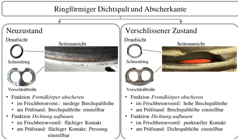
Abbildung 9.10: Abstraktion des ringförmigen Dichtspalts und der Abscherkante des Frischbetonventils zum Prüfstand (in Anlehnung an betreute Abschlussarbeit [107, S. 52]; Fotos in Draufsicht [108, S. 4-6])
