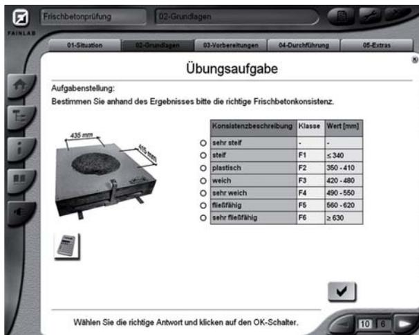
Abb. 3: Berechnung zum Ausbreitversuch
