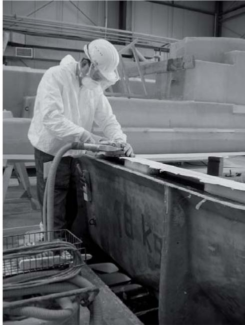
**Abb. 1:** Werker beim Besäumen eines Bauteils mit handgeführter Maschine
