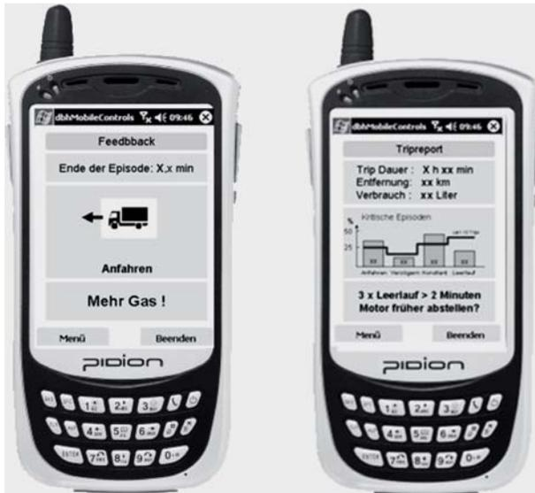
**Abb. 1:** Mobiles Endgerät als Systemplattform. Links: Feedback im Fahrprozess. Rechts: Trip Report.
