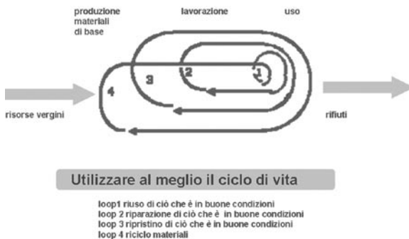
Figura 1 – Utilizzazione al meglio del ciclo di vita attraverso l'implementazione per loop successivi che massimizzano l'energia investita per la produzione (Archivio: rielaborazione grafica da The product-life Institute, Geneva).
