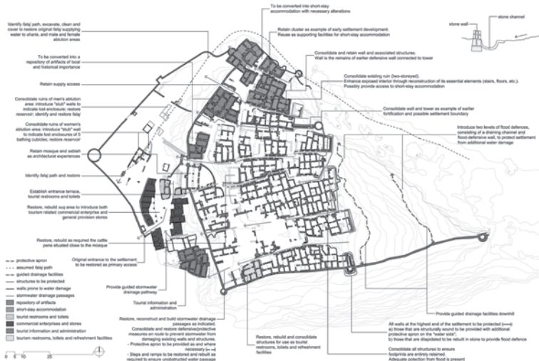
Master Plan per Hārat as-Sulayf (Ibrī, Oman) per il recupero selettivo di abitazioni e spazi aperti e il consolidamento e restauro delle strutture in mattoni di fango. / Master Plan for Hārat as-Sulayf (Ibrī, Oman) for the selective rehabilitation of dwellings and open spaces and the consolidation and restoration of mud brick structures (©MHC).
