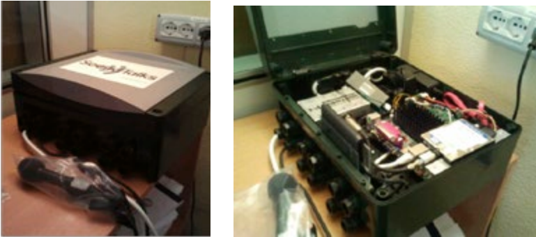
Fig. 3. Apparecchiatura per il monitoraggio sonoro della tosse in allevamento.
