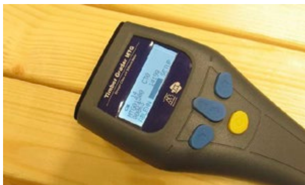
Fig. 1. Classificatore a macchina Brookhuis MTG AB
