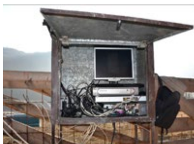
Fig. 5. Stazione di registrazione UWB e Video
