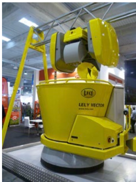
Fig. 14. Carro-robot per la preparazione e la distribuzione automatica degli alimenti.
