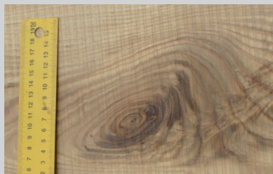
Figura 8 – Nodo sano e aderente nell'uso strutturale.
