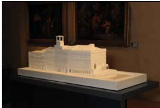
Fig. 7. Riproduzioni in scala realizzate con tecniche di additive manufacturing per la Galleria Nazionale dell'Umbria, dove è stato allestito un percorso di modelli tattili-didattici nato e pensato per i non vedenti. I modelli rappresentano la piazza IV Novembre e il Palazzo dei Priori (nella foto)
