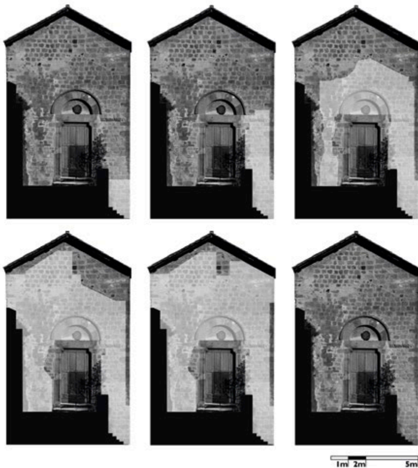
Figura 6 – Chiesa di Sant' Andrea; dall'alto a sinistra le fasi 1-5. L'ultima immagine raffigura l'aspetto attuale della facciata nel rilievo fotogrammetrico. Fasi 1 e 2: XII-XIII secolo; fase 3: fine del XIII secolo; fase 4: XVIII secolo; fase 5: XIX secolo.
