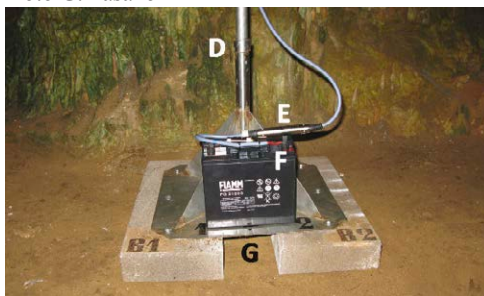
Figura 3 – A lato, il sistema di monitoraggio: A) schermo di protezione, B) modulo Sensori: temperatura, umidità relativa e tasso di CO 2 , C) modulo acquisizione e memorizzazione dati. Sotto, il sistema di alimentazione e di supporto: D) palo di supporto e base, di acciaio inox, E) connettore polarizzato per il collegamento all'accumulatore, F) batteria di accumulatori, G) basamento di cemento di 500 x 500 x 50 mm. Foto G. Fasano
