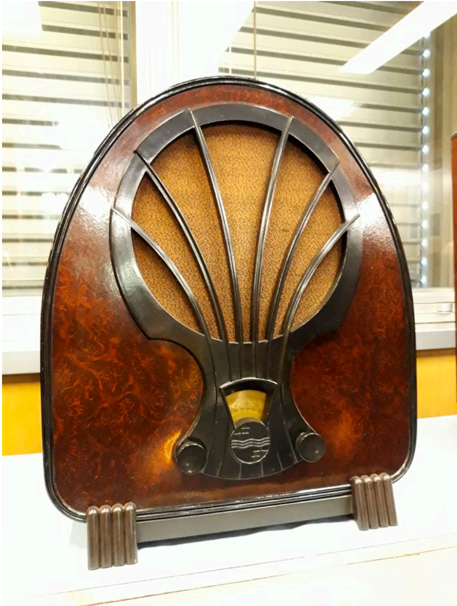
PHILIPS 830AS Svizzera 1931/32, amplificazione diretta 5 valvole OM-OC.
