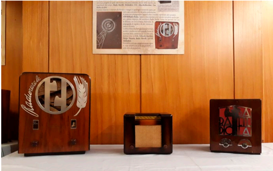
Radio popolari italiane anni 30. A sx SAVIGLIANO Radio Rurale 1935, supereterodina 5 valvole onde OM. Al centro CGE Radio Balilla 1937, reflex 3 valvole onde OM. A dx CGE Radio Roma 1939/40, supereterodina 3 valvole.
