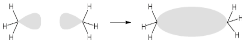
Figura 2 - Rappresentazione grafica dell'orbitale molecolare \sigma del legame C-C dell'etano, per sovrapposizione di orbitali sp^3 .
