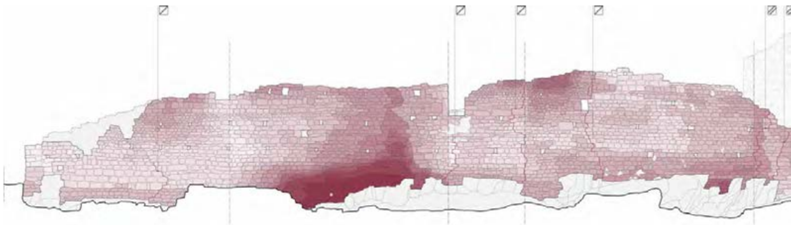
Figura 10 UT 13, cinta muraria interna, rilievo dei degradi architettonici
