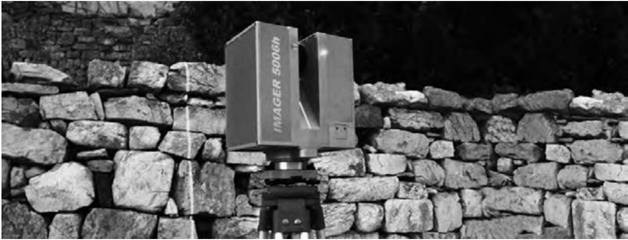
Figura 1 Laser-scanner Zoller+Fröhlich Imager 5006H in fase di acquisizione
