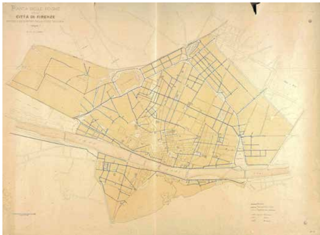
Fig. 45 Pianta delle Fogne della Città di Firenze entro il perimetro della Cinta Daziaria, 1893, litografia, 67 x 93,2 cm (ASCFi, Fondo Disegni, car. 377/014). Assetto delle fognature realizzate a partire dagli anni Sessanta dell'Ottocento.
