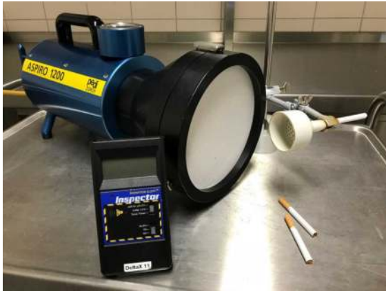
(a) Mit Luftsammler und Zigaretten kann die Radioaktivität von Tabakrauch nachgewiesen werden.
