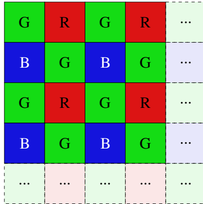
Abbildung 4.1: Beispielhafte Anordnung des Farbfilmarrays bei einem Sensor mit Bayer-Muster.
