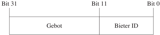
Abbildung 4.27: Beispielhafte Partitionierung eines 32-Bit Wertes zur Repräsentation von sowohl Gebot als auch Person.
