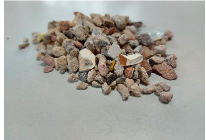
(b) Mineralischer Bauabbruch
