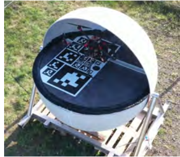
Abbildung 4.2: Kugelhangar beim Schließvorgang
