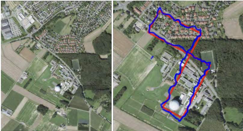
Abbildung 5.1: Links ist eine Luftaufnahme des Referenzgebiets zu sehen, in dem die Position gesucht wurde. Rechts sieht man die ermittelten Positionen (blau) und die Referenzpositionen, die durch das GPS+RTK ermittelt wurden (rot). Die drei blauen Punkte über dem Acker (links, Mitte) stellen Fehllokalisierungen dar.
