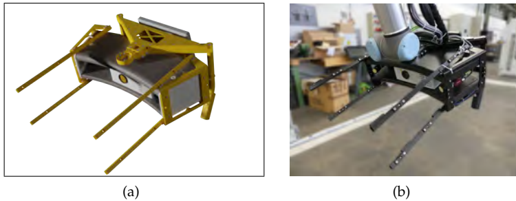
Abbildung 2.2: Modifizierter Streifenlichtsensor: (a) CAD-Modell mit zusätzlicher Augmented-Reality-Kamera, Tracking-Skelett, Griffen und Touchscreen. (b) die Umsetzung am Inspektionsportal.
