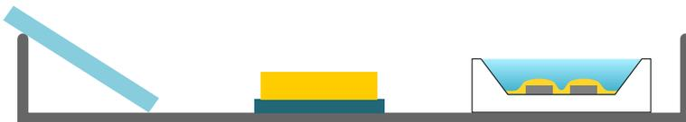
**Abbildung 3.9:** Schematische Darstellung der Anordnung der Proben zur Alterung auf dem Ofenblech. Von links nach rechts: Klarsilikonplättchen, Konversionselement und LED.
