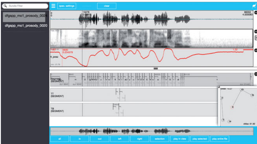
Abb. 8.1: Emu WebApp Labeler mit drei Signaldarstellungen (Oszillogramm, Sonogramm, EMA-Sensormessdaten), drei Annotationsebenen (Segment, TT [ tongue tip ] und TB [ tongue back ]) sowie einer Visualisierung der Bewegungen der EMA-Sensoren in einem eigenen Fenster unten rechts.
