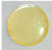
Abb. 14: hydrophiler Linsenrohling zur Fertigung einer IOL
