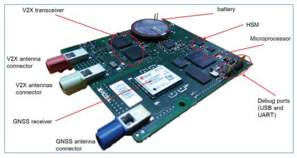
Figure 20. V2X module hardware.
