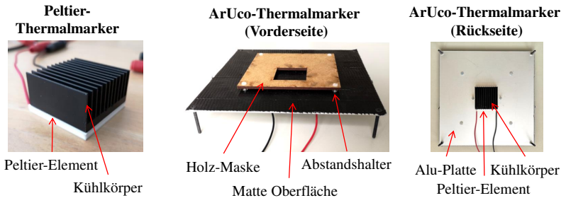
Abbildung 4.10: Entwickelte Peltier-Thermalmarker (links) sowie ArUco-Thermalmarker (Mitte und rechts).
