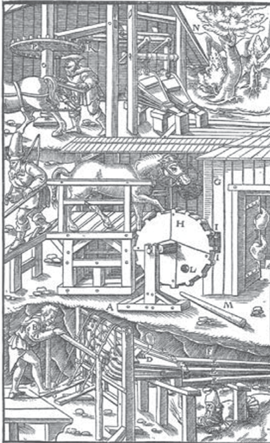
Die zuerst beschriebene Maschine A. Der Arbeiter, der durch Treden die Bälge zusammendrückt B. Die Bälge ohne Mundstücke C. Die Öffnung, durch welche die schweren Wetter oder die Luft ausgeblasen werden D. Die Latten E. Der Sollen F. Die zweite beschriebene Maschine G. Die hölzerne Trommel H. Ihre Stufen I. Die Umfassung K. Das runde Loch in der Trommel L. Die Stange M. Die dritte beschriebene Maschine N. Die stehende Welle O. Ihr Zahnrad P. Die liegende Welle Q. Ihr Gehäuse R.
