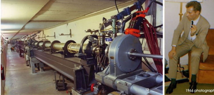
Fig. 3.4 The Orsay linear accelerator wave guide, credits Laboratoire de l’Accélérateur Linéaire d’Orsay , and Pierre Marin (1927–2002) in a 1966 photograph. Credit: Yvette Haïssinski
