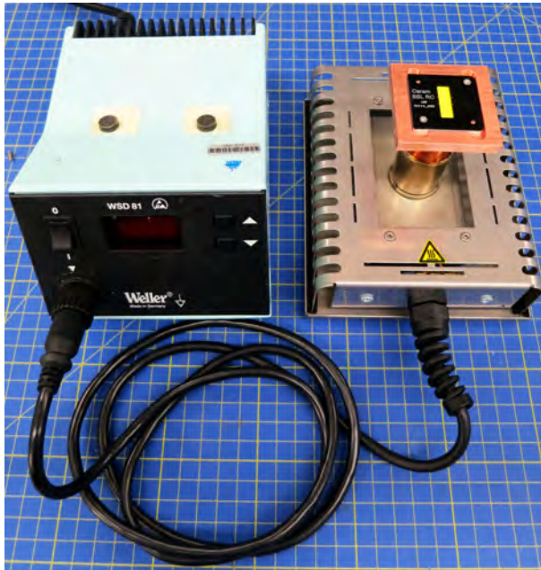
Abbildung 6.3: Umfunktioniertes Lötbad zur Erwärmung des Konverters zur Ermittlung des Emissionskoeffizienten.
